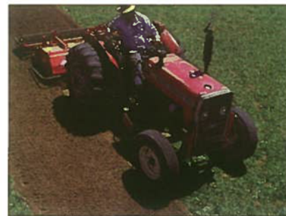
Les fibres et le sol peuvent se mélanger uniformément avec le matériel standard de terrassement et d'entretien.
