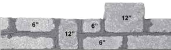
Répartissez les pierres de 12 po de manière égale sur l'ensemble du mur. Utilisez un joint d'assise de mortier de 1/2 po pour conserver la répartition des pierres de 12 po. Utilisez un burin ou un séparateur pour couper les pierres lorsque cela est nécessaire. (Portez des lunettes protectrices).
