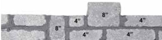
Répartissez les pierres de 8 po de manière égale sur l'ensemble du mur. Utilisez un joint d'assise de mortier de 1/2 po pour conserver la même hauteur de 8 po. Utilisez un burin ou un séparateur pour couper les pierres lorsque cela est requis (Portez des lunettes de protection).
