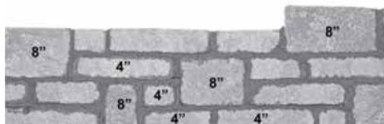
Exposez la face texturée aux ouvertures et aux coins. Essayez toujours de ne pas avoir de joints de mortier d'une hauteur supérieure à 8 po et de décaler les pierres de 2 po au minimum.
