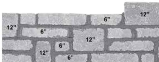
Exposez les faces texturées aux ouvertures et aux coins. Essayez toujours de ne pas dépasser une hauteur de 12 po pour les joints verticaux et d'avoir un minimum de décalage de 2 po entre les joints verticaux qui se superposent.
